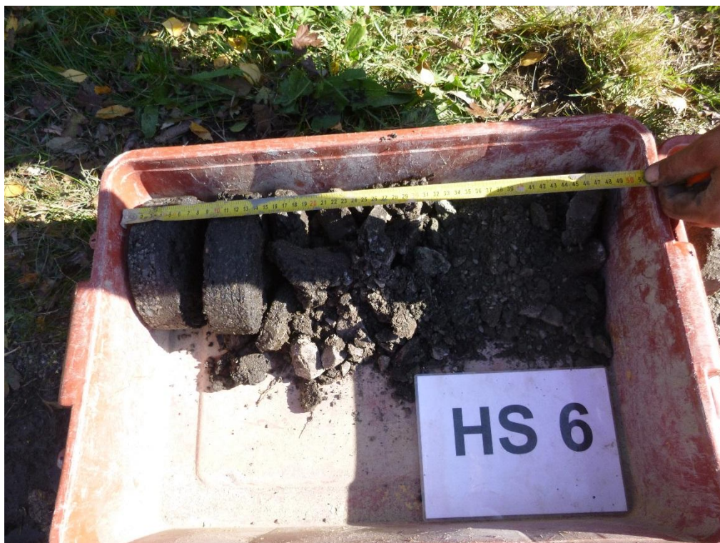
Obr. 12 Vzorkovnice 1/3 vrtu HS6, most 305-019 Štěpánov u Skutče
